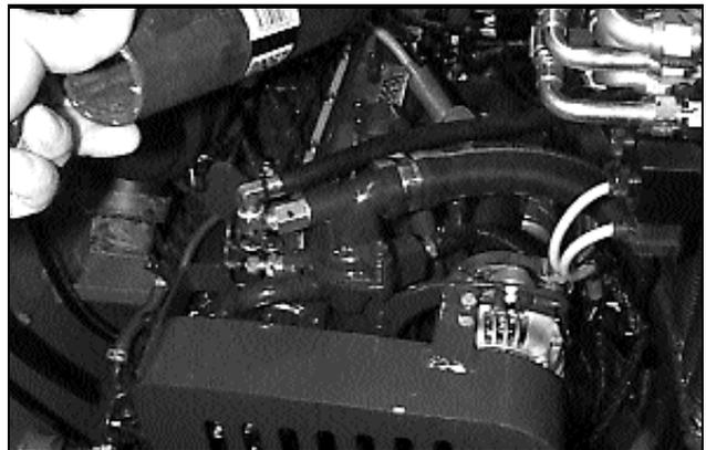
Disconnect fan wiring
